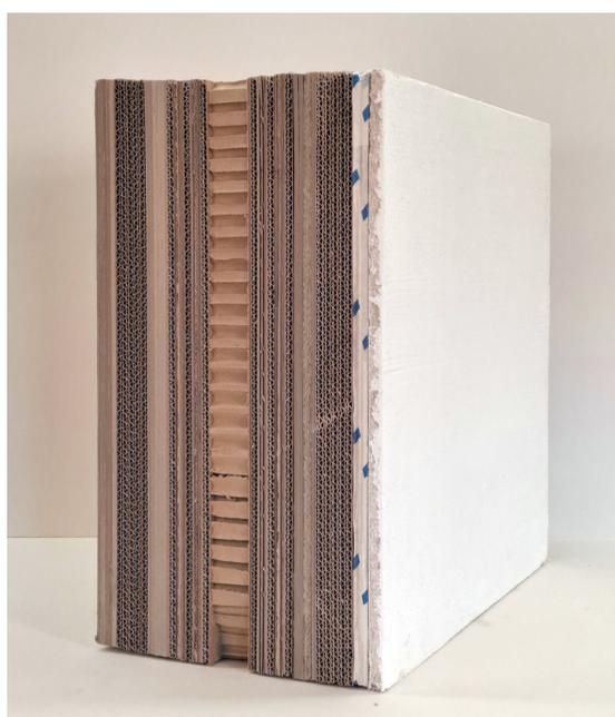
Bild eines 50 x 50 cm Prototyps der Subvariante 1.2a, massive, functional geschichtete Struktur. TUDa 2024.
