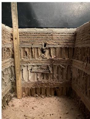
Fußbodenaufbau (links), Positionen der Messsensoren (rechts). TUDa 2023.
