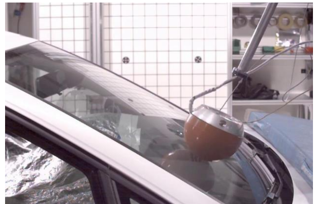
Kopfaufprallversuch an einer Frontscheibe
