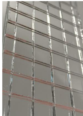
Kontrolliert gebrochene Probekörper im Voronoi- (links) und Karo-Muster (rechts).
