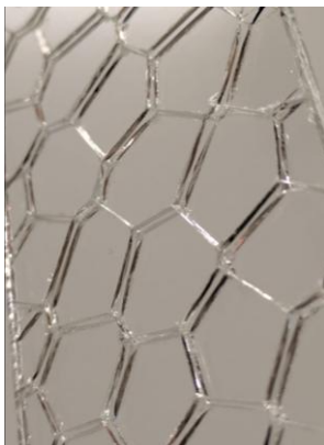
Kontrolliert gebrochene Probekörper im Voronoi- (links) und Karo-Muster (rechts).
