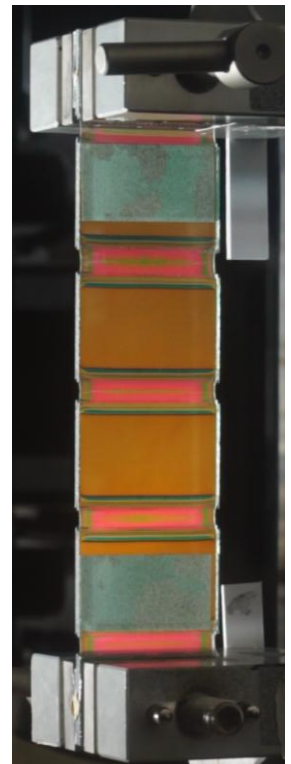
Delaminationszustände im Zugversuch im Voronoi-Muster (links) und mit photoelastischer Messung (rechts).
