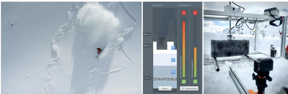
In der modernen Bruchmechanik hat sich bei der Versagensvorhersage von Rissen ein gekoppeltes Kriterium aus Festigkeit und Bruchzähigkeit etabliert. Zweites beschreibt den Widerstand gegen Risswachstum. Fortschritte bei der Bestimmung dieser Materialparameter für Schwachschichten ermöglichen erstmals die Entwicklung eines schlüssigen Versagenskriteriums aus mechanischer Sicht, um die Auslösung von Schneebrettlawinen vorherzusagen.
