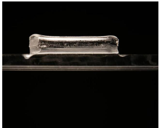
Beispielhafte 3D bedruckte Glasplatten
