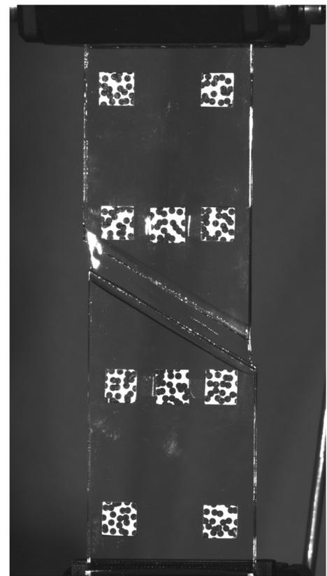
Zugversuch mit definierter Risskonstellation
