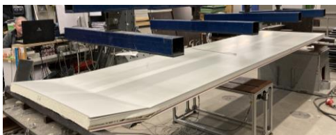
Schubbruch in einem Sandwichelement
