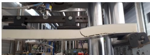
Schubbruch in einem Sandwichbalken
