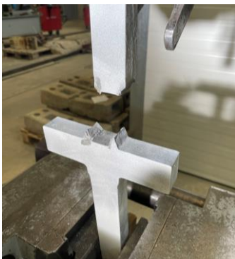
Bild 1: experimentelle Untersuchungen und ANSYS-Modell einer DHY-Naht
