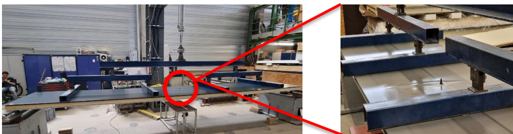
Bild 1: 6-Punkt-Biegeversuch eines Sandwichelements mit lokaler Fehlstelle
